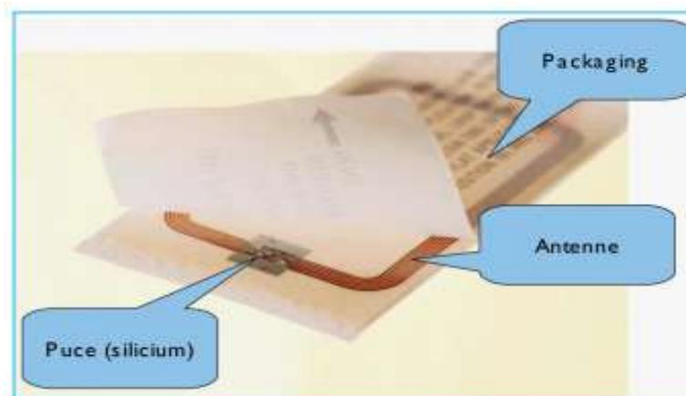
Les étiquettes radiofréquences, également appelées tags, sont constituées de deux éléments :
