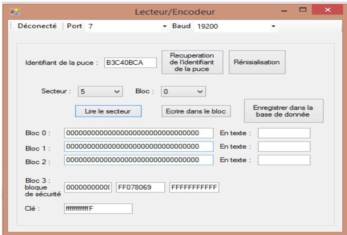
Pour réaliser un enregistrement dans une puce on ne peut pas enregistrer directement une chaîne brute, il faut réaliser une conversion " caractère de la chaîne en code ASCII hexadécimal des caractères décomposés ".
